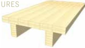
L'utilisation d'éléments nervurés permet de réduire la quantité du bois, tout en augmentant la portée et peut être obtenue directement auprès de KLH®. Si la hauteur de la section est inévitablement un peu plus élevée, l'espace intermédiaire peut, selon la configuration des nervures, être utilisé pour l'isolation acoustique ou comme espace d'installation pour le passage de gaines techniques.
