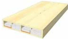
Les éléments de caissons KLH® sont souvent constitués de nervures, sur ou sous l'élément KLH®, et d'une couche plus fine pour fermer les cavités. À l'instar des panneaux nervurés ouverts, ces cavités sont disponibles pour diverses installations et mesures d'isolation acoustique. Les caissons conviennent particulièrement bien pour intégrer des lestages (par ex. remplissage en vrac) dans les éléments.
